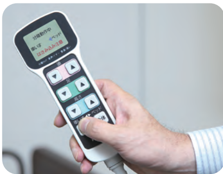
リモコン操作で簡単に分離できる「リシヨーンPlus」は、ベッドから車いすへの移乗介助自体をなくし、介護する人の負担を大幅に軽減した。また、利用者を気軽に離床させることができることから、離床時間を増やし、利用者の日常生活も大きく変えることができる
