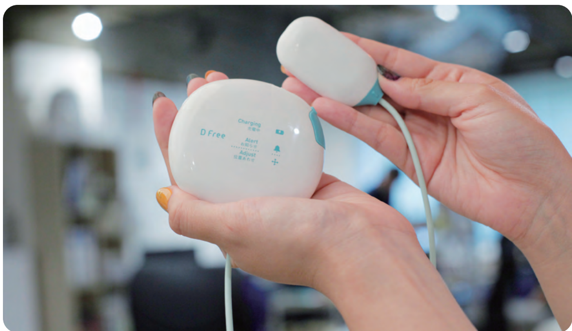
「DFree」とは、英語で「diaper free＝おむつ要らず」の意味。手のひらサイズの小さな装置で、丸みを帯びたデザインが、親しみやすさを感じさせる。エコーにより腸内をモニターし、スマホの専用アプリで排泄のタイミングを知らせてくれる
