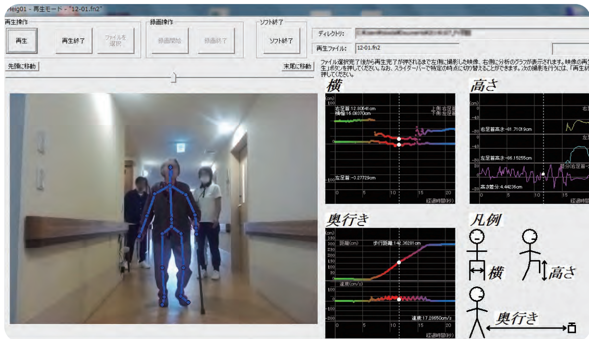
ジェスチャーや音声認識によって操作ができるマイクロソフト社のデバイス「Kinect」を活用し、センサーによって体の動きを骨組みから認識する装置を開発、入居者の「歩行測定プログラム」を作った。これにより、転倒事故の30%以上の減少につなげる
