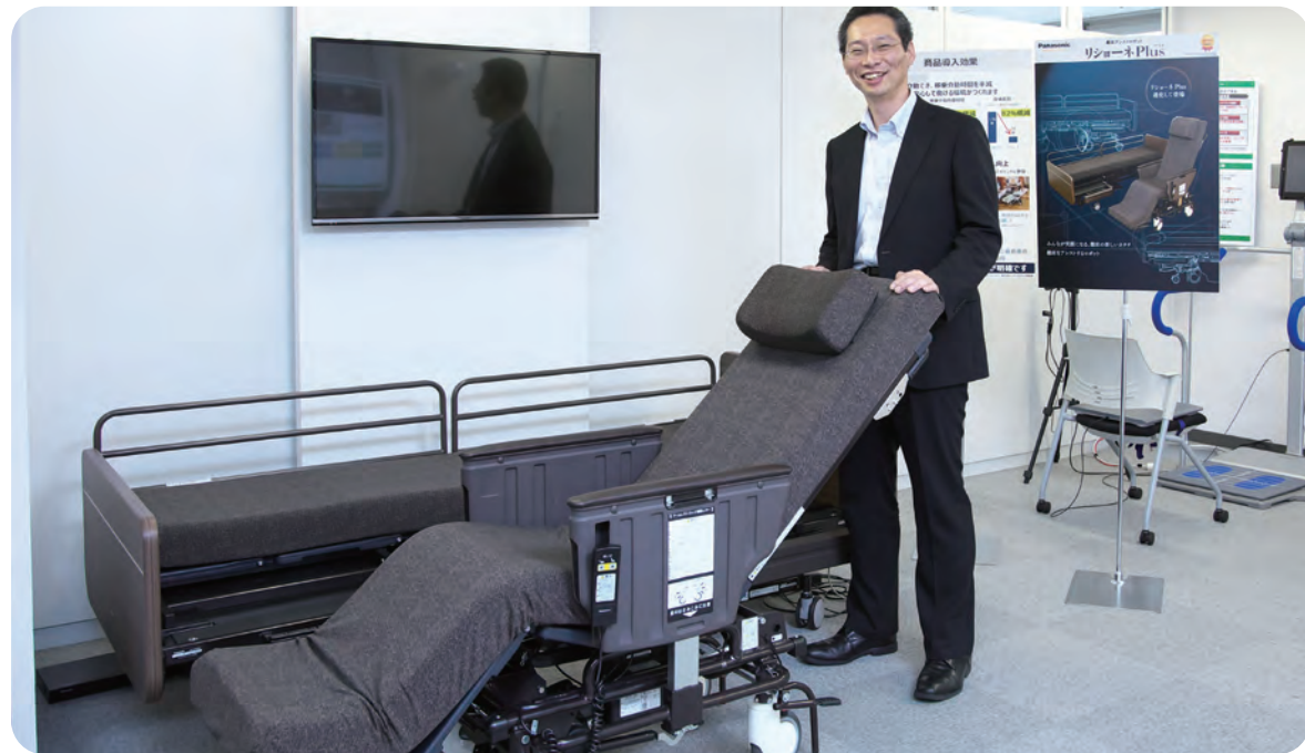
次世代機「リシヨーンPlus」。それまで右側だけの配置だった車いす部分が、納入時に左右どちらか選べるようになった。3層から成る体圧分散ウレタンマットレスは、分割部分の滑らかさに配慮。体圧がかかることで分割部分がびったりとくっつき、段差は生じない
