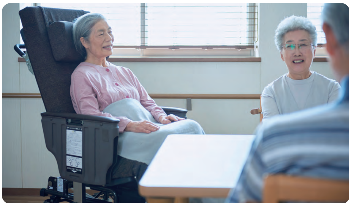
リモコン操作で簡単に分離できる「リシヨーンPlus」は、ベッドから車いすへの移乗介助自体をなくし、介護する人の負担を大幅に軽減した。また、利用者を気軽に離床させることができることから、離床時間を増やし、利用者の日常生活も大きく変えることができる
