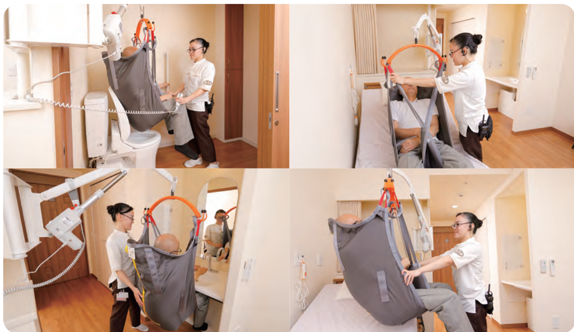
オリックス・リビングが介護用品メーカーと共同開発した壁収納型介護リフト。介護スタッフ1名で楽に装着でき、いつでもすぐに使うことができる。360度の多関節自在アームにより、ベッドから洗面台、トイレに素早く移動可能。トイレ介助も楽々に
